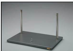
Zwei Stützen in Grundplatte hineinschrauben
